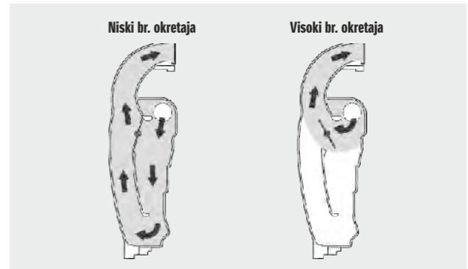
PROTOK ZRAKA KOD VIŠESTUPANJSKOG USISNOG SUSTAVA
